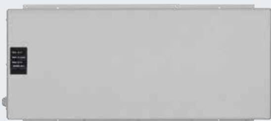
Источник бесперебойного питания для перехода на аварийное питание при отключении напряжения в течение макс. 4 часов; устройства обеспечения безопасности, сигнальные лампы и т.д. сохраняют свои функции, светодиод индикации состояния, автоматическое тестирование аккумулятора, фильтр перенапряжения Размеры: 560 x 235 x 260 мм (Ш x В x Г) Класс защиты: IP 20
